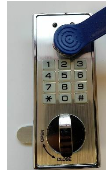
3. Apresentar a chave Mestra (Se adicionada correctamente a fechadura emite 4 bips curtos )
